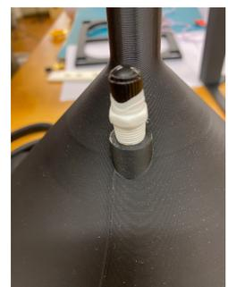
Problem, da der Speicher unter Druck arbeiten muss, um realistische Bedingungen zu erzeugen. Die Konsequenz war, dass die Messungen in einem engen Zeitfenster direkt nach dem Befüllen erfolgen mussten. In geringem Maß trat auch Wasser aus, was die Funktion aber kaum beeinflusste.
